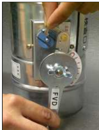
ホルダーをねじ込みフックを かけて完成です。 あとは使用状況の風量調整に 合わせてください
